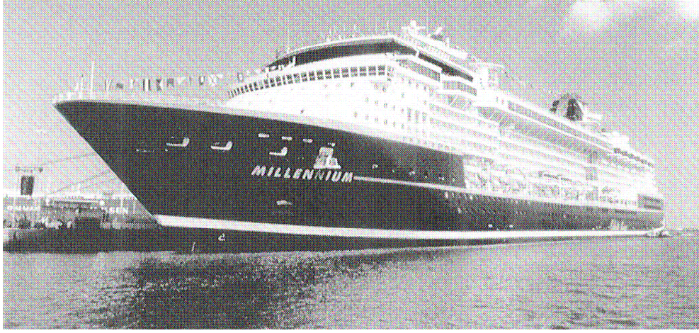
Şekil 3.4 Celebrity Cruises’ Millennium class (Toplam 59 MW güç kapasitesinde 2 adet LM2500+ gaz türbini-jeneratör seti ve 1 adet buhar türbini jeneratörüne sahiptir) (Sanneman, 2004)
