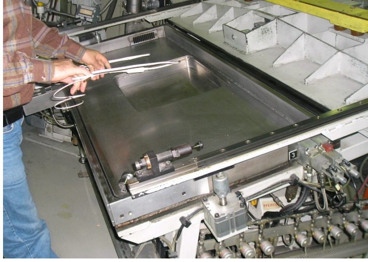
Şekil 4.14 Helyum gaz şarj odasında kaçak kontrolü
