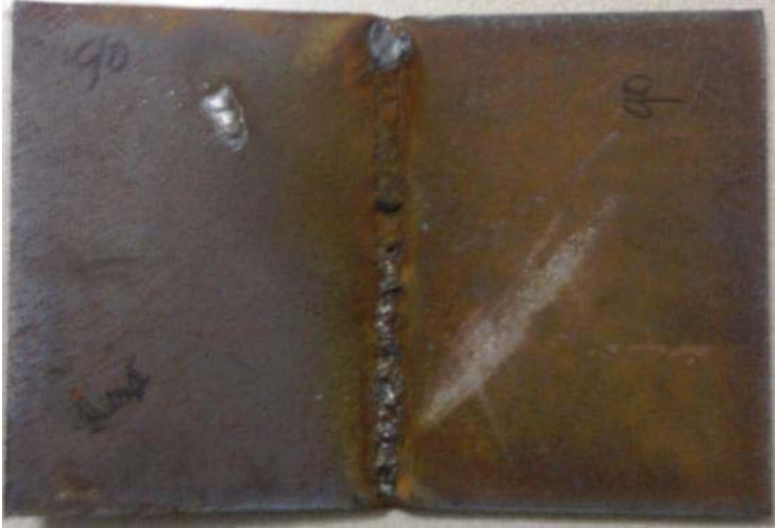
Şekil 6.26: 90° - (V) Kaynak ağızı ile kaynak edilmiş parça
