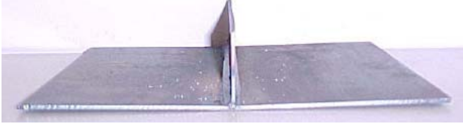
Şekil 5.44: Deney 3'de meydana gelen açısal distorsyon
