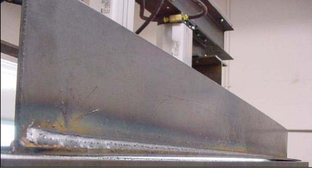
Şekil 5.32: Deney 2’de yapılan kaynak sonucu oluşan konstrüksiyon. Boyuna eğilme resimde belli olmaktadır.
