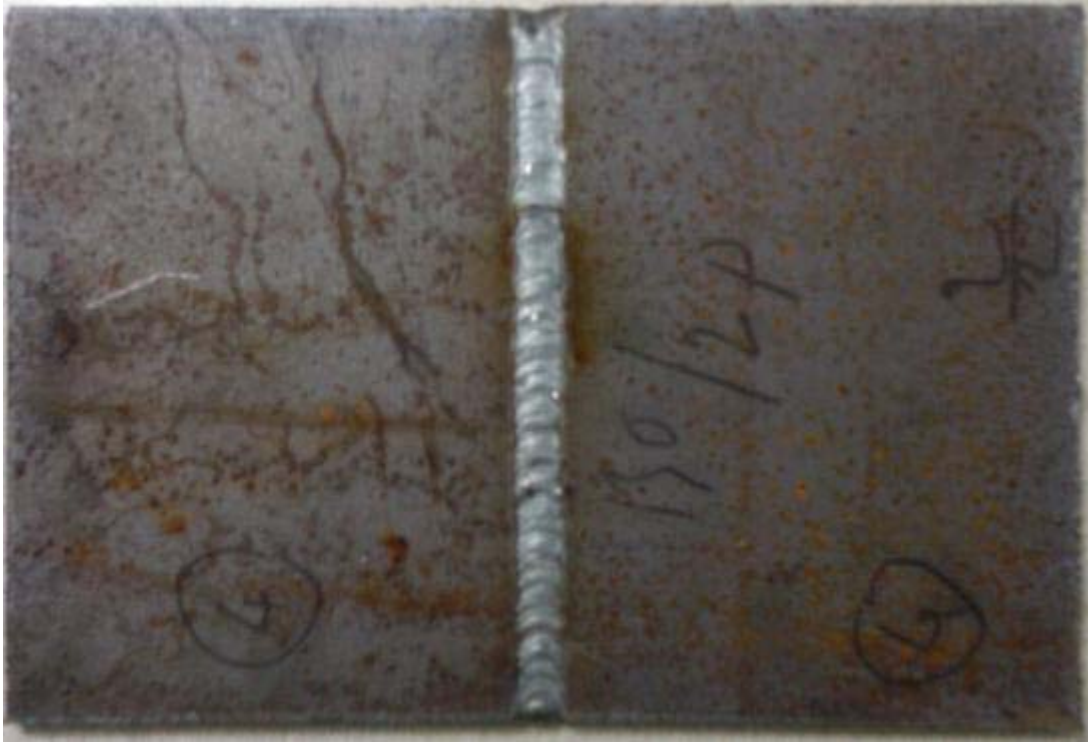
Şekil 6.29: (X) Kaynak ağızı 90° ile kaynak edilmiş parça
