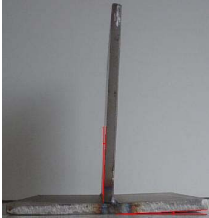
Şekil 6.18: İç köşe kaynağı, tek taraftan sürekli kaynak
