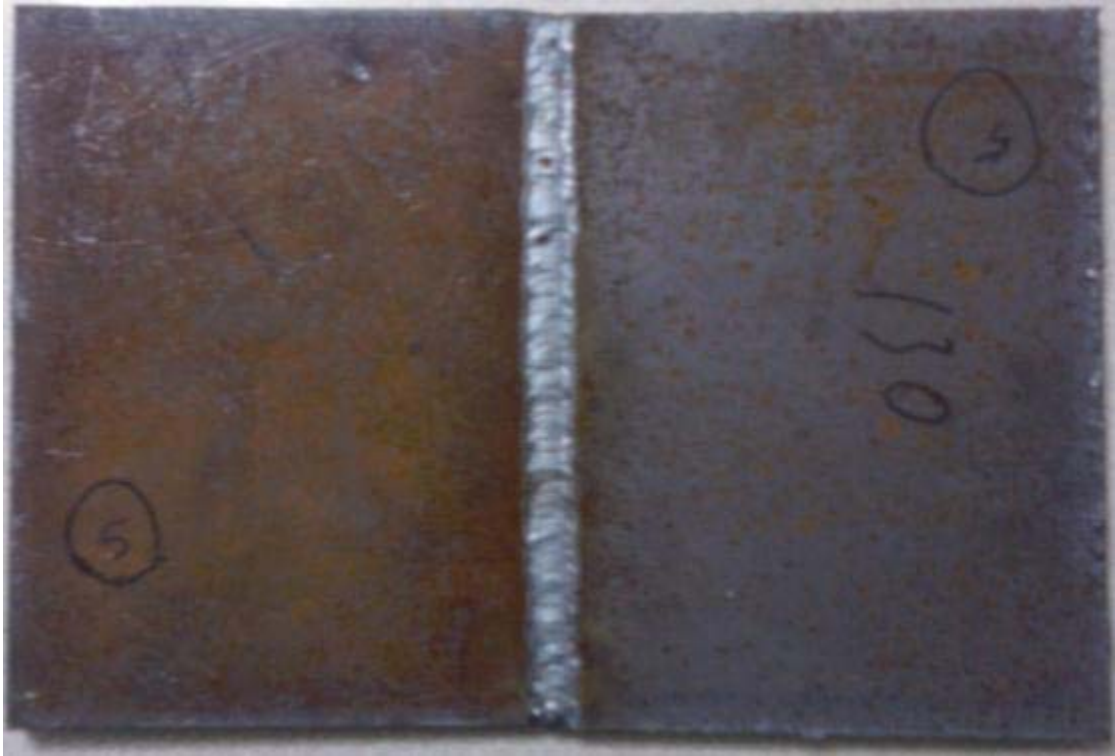
Şekil 6.31: (Y) Kaynak ağızı 60^\circ açı ile hazırlanmış parçanın kaynağı
