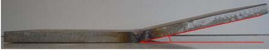
Şekil 6.4: 70° - (V) Kaynak ağızı ile kaynak edilmiş parça
