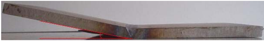
Şekil 6.16: (V) Kaynak ağızı 60^\circ açı ile hazırlanmış parçanın kaynağı
