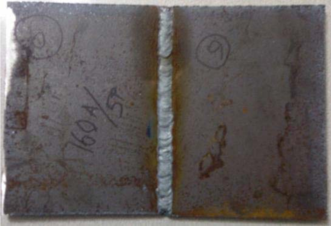
Şekil 6.32: (V) Kaynak ağızı 50^\circ açılı ile hazırlanmış parçanın kaynağı
