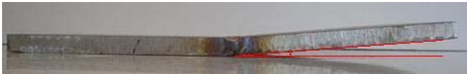
Şekil 6.2: 45° - (V) Kaynak ağızı ile kaynak edilmiş parça
