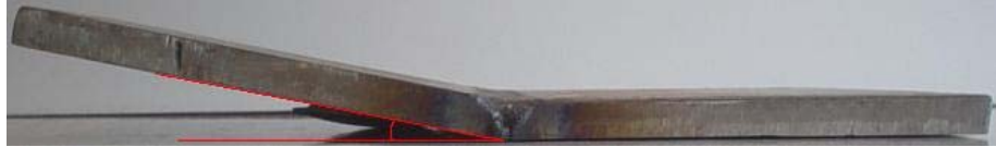
Şekil 6.14: (V) Kaynak ağızı 50^\circ açı ile hazırlanmış parçanın kaynağı
