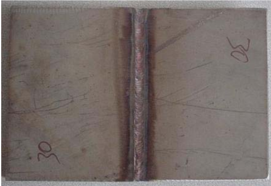
Şekil 6.1: 45° - (V) Kaynak ağızı ile kaynak edilmiş parça
