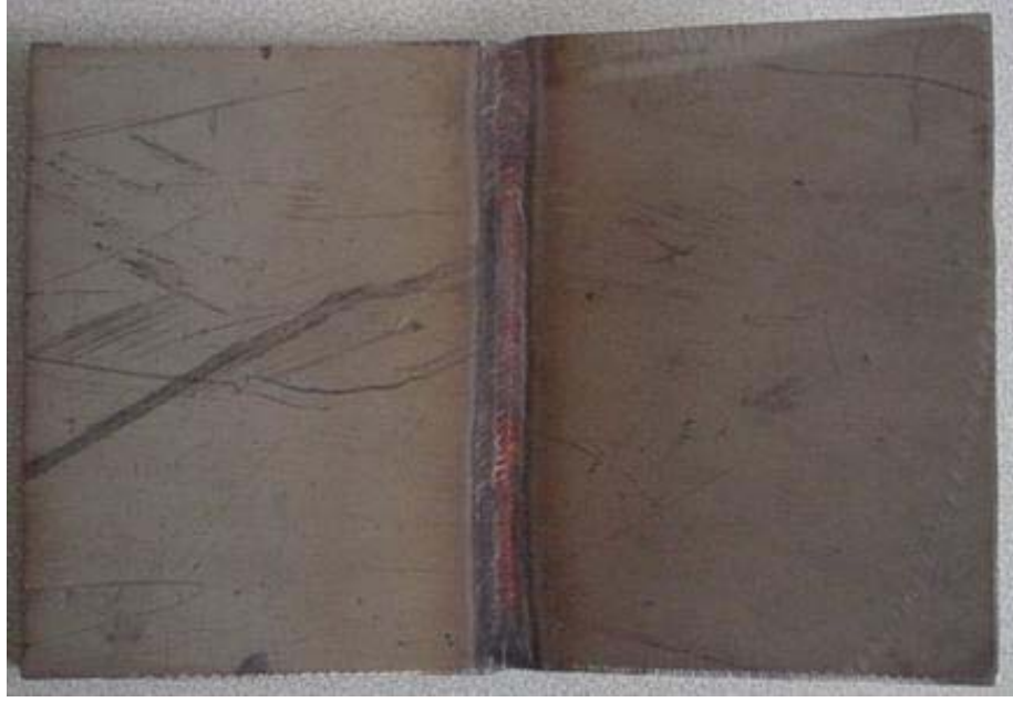
Şekil 6.5: 90° - (V) Kaynak ağızı ile kaynak edilmiş parça
