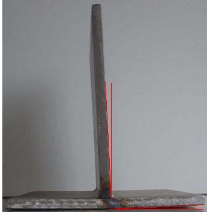
Şekil 6.22: İç köşe kaynağı, çift taraftan kesikli kaynak
