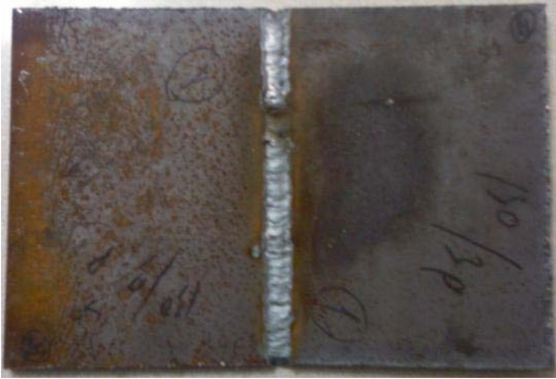
Şekil 6.23: 45° - (V) Kaynak ağızı ile kaynak edilmiş parça
