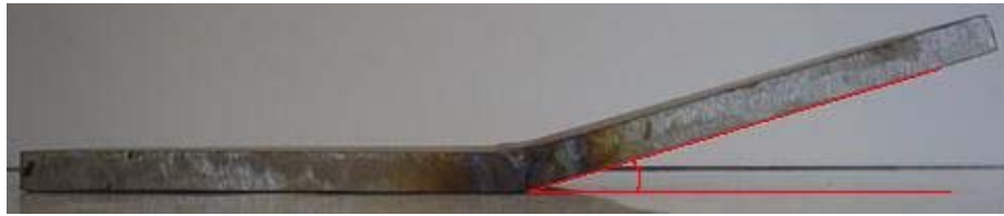
Şekil 6.6: 90° - (V) Kaynak ağızı ile kaynak edilmiş parça
