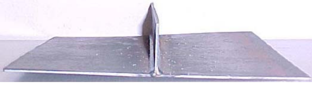
Şekil 5.43: Deney 1'de meydana gelen bükülme
