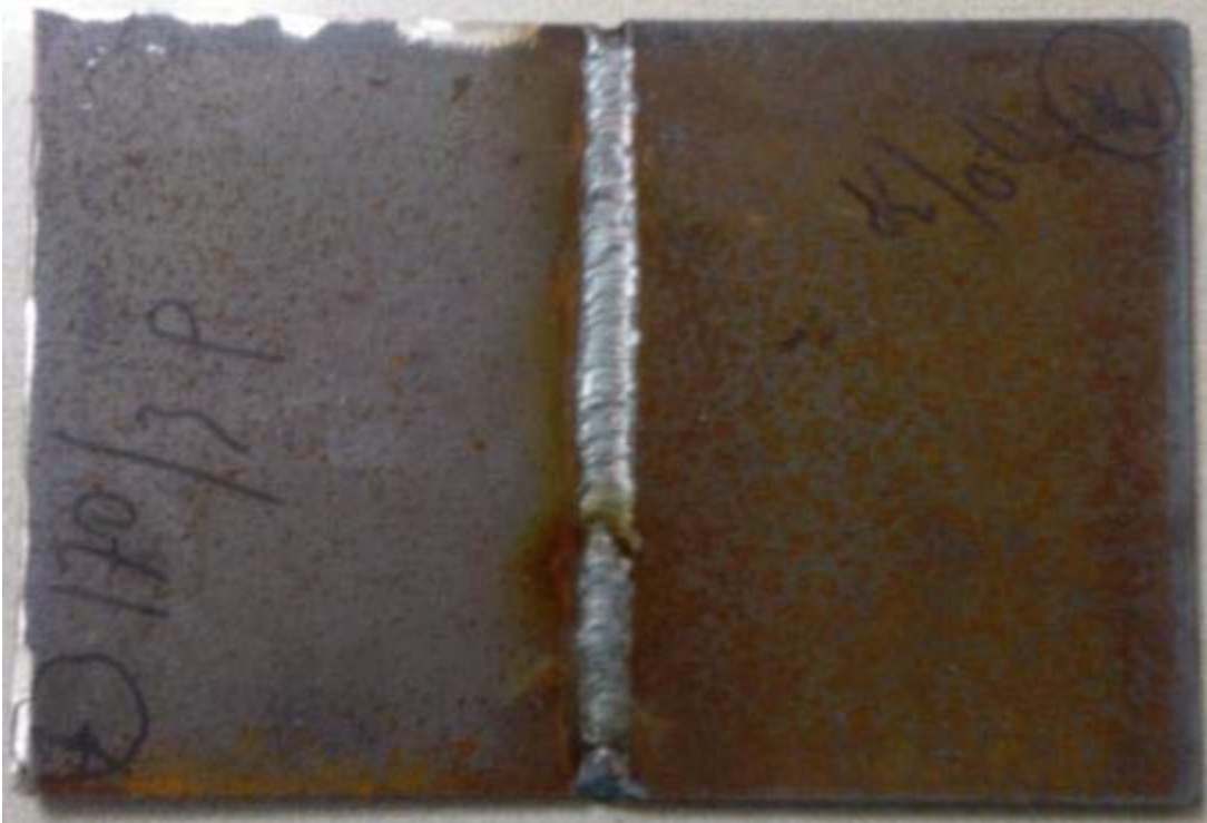
Şekil 6.34: (V) Kaynak ağızı 60^\circ açı ile hazırlanmış parçanın kaynağı
