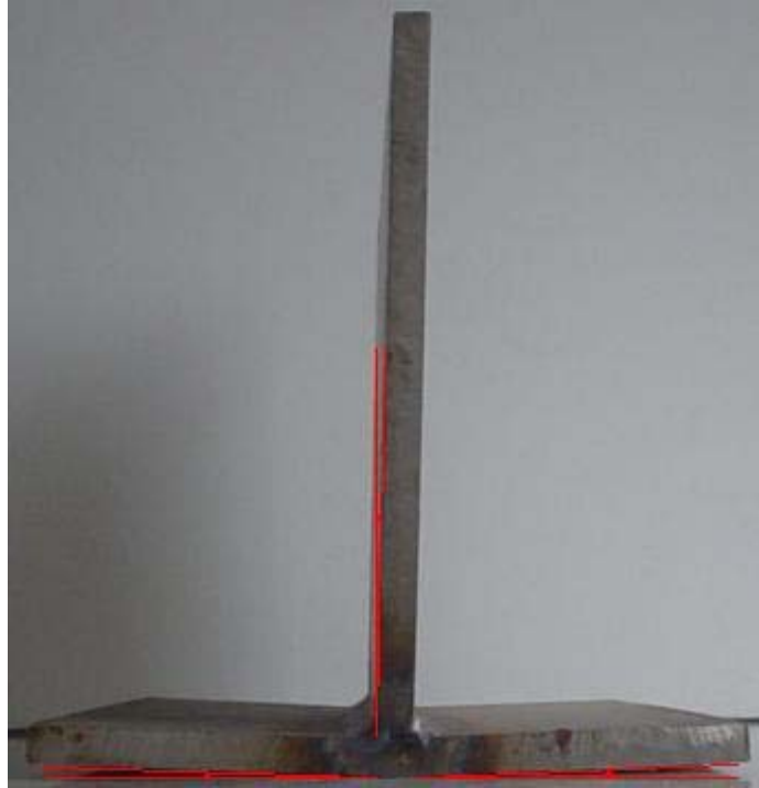
Şekil 6.20: İç köşe kaynağı, çift taraftan sürekli kaynak
