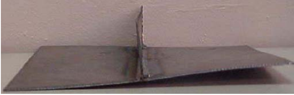
Şekil 5.37: Deneý 1’de meydana gelen bükülme
