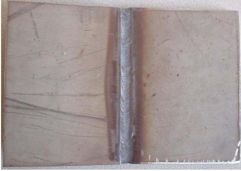
Şekil 6.15: (V) Kaynak ağızı 60^\circ açı ile hazırlanmış parçanın kaynağı
