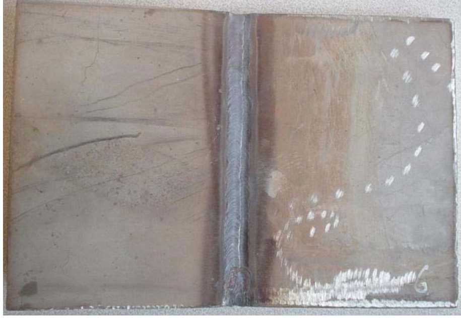
Şekil 6.13: (V) Kaynak ağızı 50^\circ açı ile hazırlanmış parçanın kaynağı
