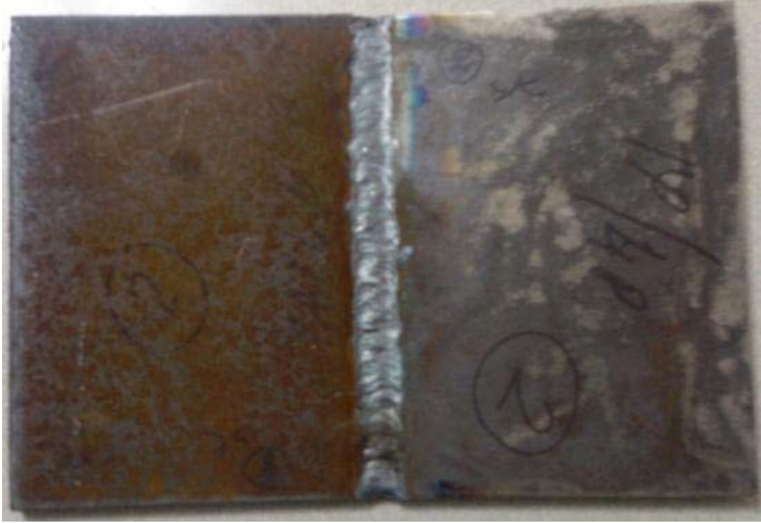
Şekil 6.24: 70° - (V) Kaynak ağızı ile kaynak edilmiş parça
