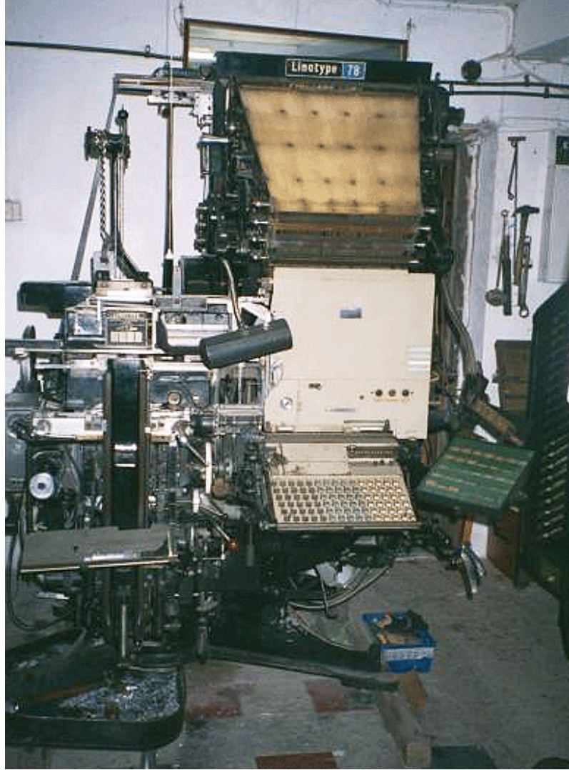
Şekil 1.1 Ottmar Mergenthhaler tarafından 1890 yılında geliştirilen, matbaa harflerinin tek bir parça halinde dökümünü sağlayan dizgi makinesi ( Smithsonian Institute, 2007)
