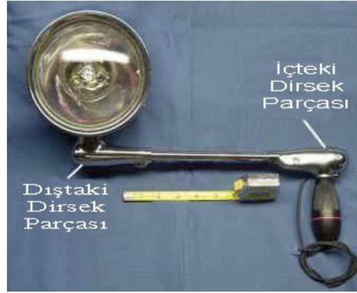
Şekil 5.2 Montajlı parçalar içerisinde dirsek kısımları.
