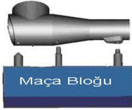
Şekil 5.7 Delikler için dizayn edilmiş maça bloğu.
