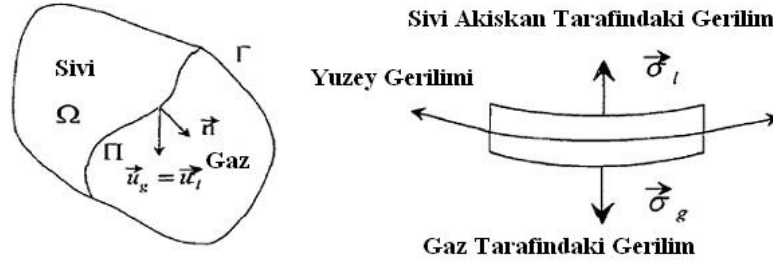
Şekil 4.5 Serbest yüzey ve serbest yüzeydeki gerilmeler(White, 1986).
