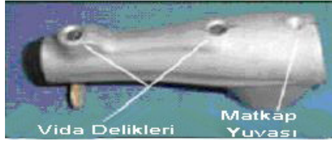
Şekil 5.5 Dirsek parçasındaki delikler.
