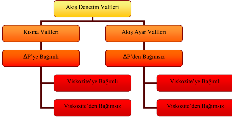
Şekil 3.36 Akış denetim valfleri. Hidrolik Devre Elemanları ve Uygulama Teknikleri Kitabı, (2001), Makine Mühendisleri Odası Yayını-292
