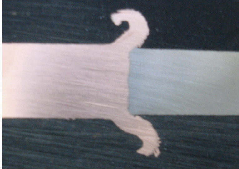
Şekil 4.25 C parametre grubu sürtünme kaynağı numunesinin makro fotoğrafı ( P_1 = 62 MPa, P_2 = 74 MPa, t_1 = 7,5 s, t_2 = 12 s )
