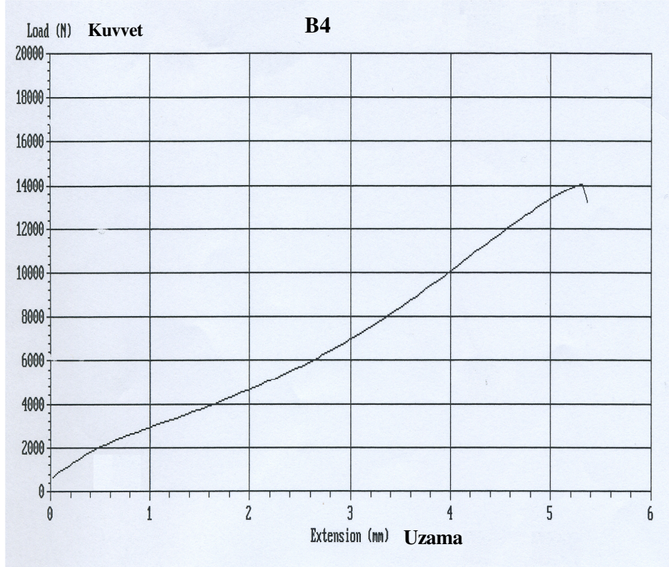
Şekil 4.9 B4 numunesinin ( P_1 = 56 MPa, P_2 = 68 MPa, t_1 = 8,5 s, t_2 = 14 s ) çekme dayanımı eğrisi
