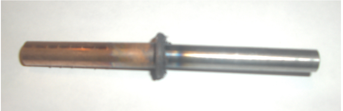
Şekil 3.11 A parametre grubu ile elde edilen sürtünme kaynağı numunesi
