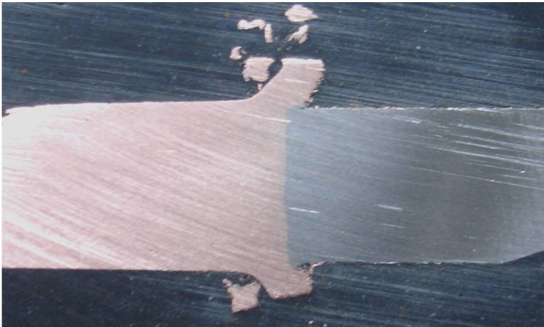
Şekil 4.26 D parametre grubu sürtünme kaynağı numunesinin makro fotoğrafı ( P_1 = 68 MPa, P_2 = 82 MPa, t_1 = 5,5 s, t_2 = 10 s )
