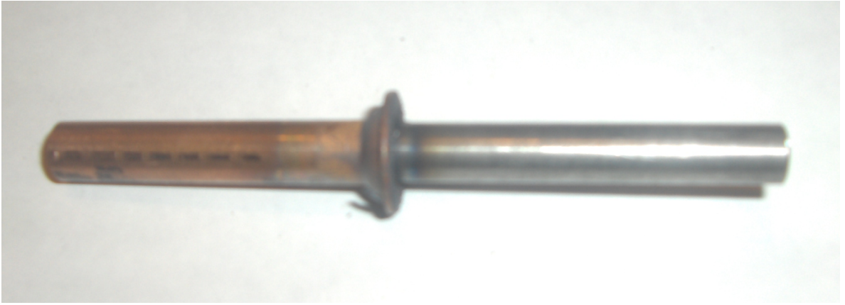
Şekil 3.13 C parametre grubu ile elde edilen sürtünme kaynağı numunesi
