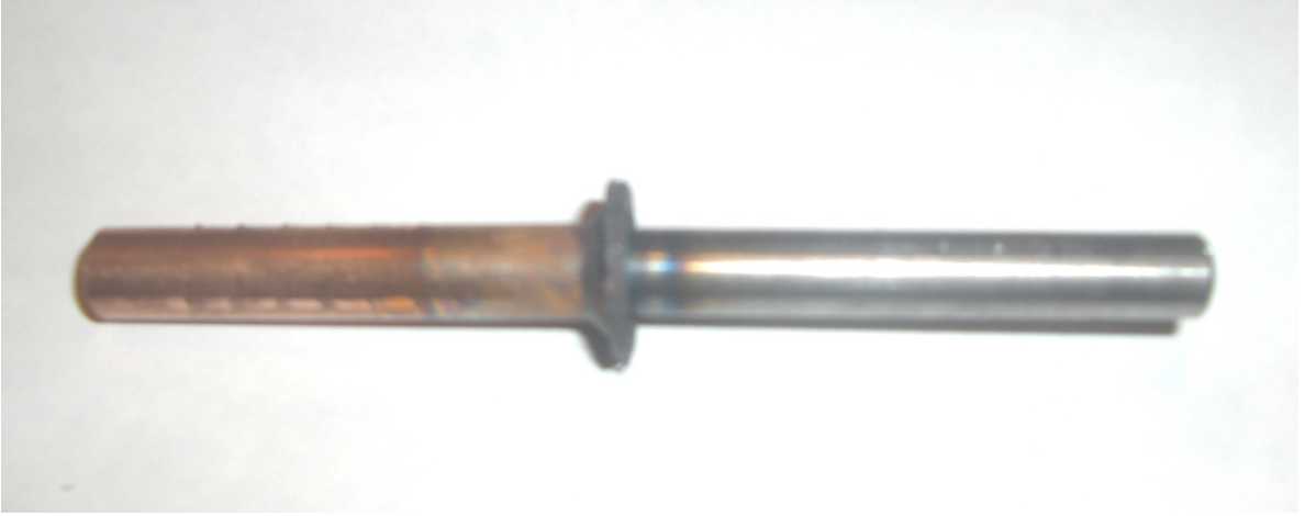
Şekil 3.12 B parametre grubu ile elde edilen sürtünme kaynağı numunesi
