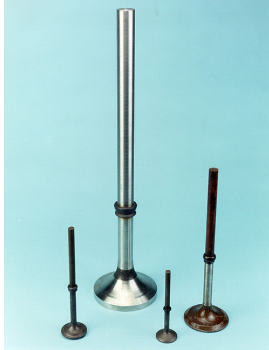
Şekil 2.13 Sürtünme kaynağı ile imal edilmiş egzoz supapları (www.mtiwelding.com)
