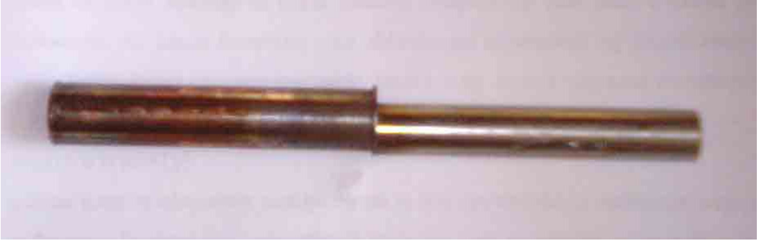
Şekil 3.4 Sürtünme kaynağı tezgahında karşılaşılan aksenal kaçıklık problemi
