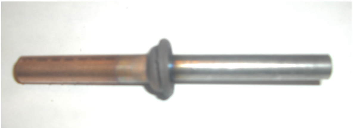
Şekil 3.14 D parametre grubu ile elde edilen sürtünme kaynağı numunesi
