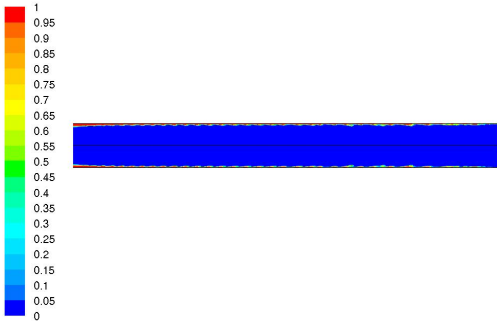
Şekil 7.2 Sıvı ve gaz fazlarının hacimsel oranları-2 t=0,14s (50mm)
