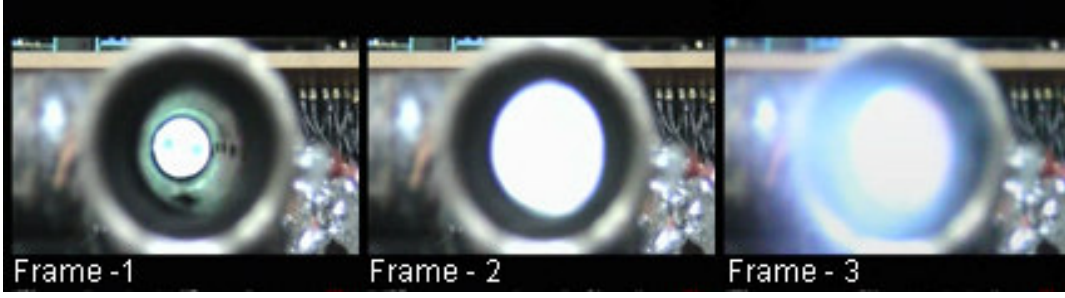
Şekil 4.59 My/Mh=1/10 , T= 25 °C Nafta denemesinde elde edilen görüntü
