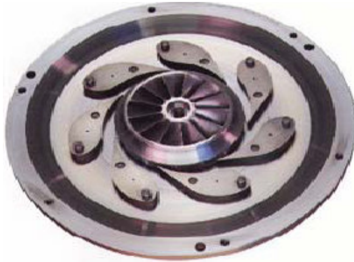
Şekil 4.7 Radyal türbin IGV'sı ve çarkı.
