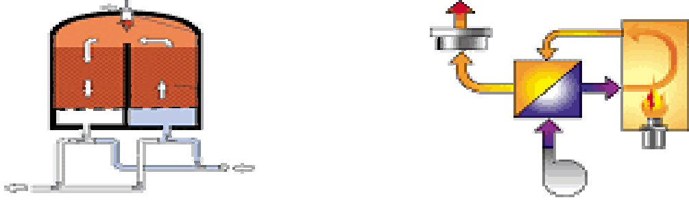
Şekil 4.3 Rejeneratif termal insineratör ve reküperatif termal insineratörün şematik gösterimi
