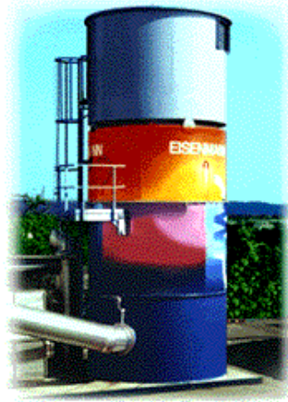
Şekil 4.6 Rejeneratif termal insineratörün uygulama örneği
