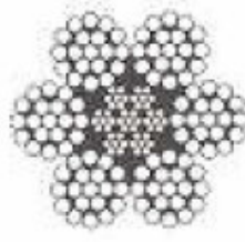
Şekil 3.6 Standart 6 x 19 çelik özlü halat
