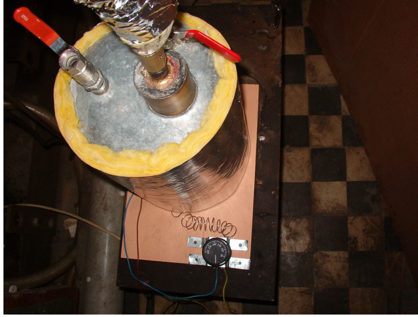
Şekil 4.3 Buhar jeneratörü (üretici), termostat üstten görünüşü
