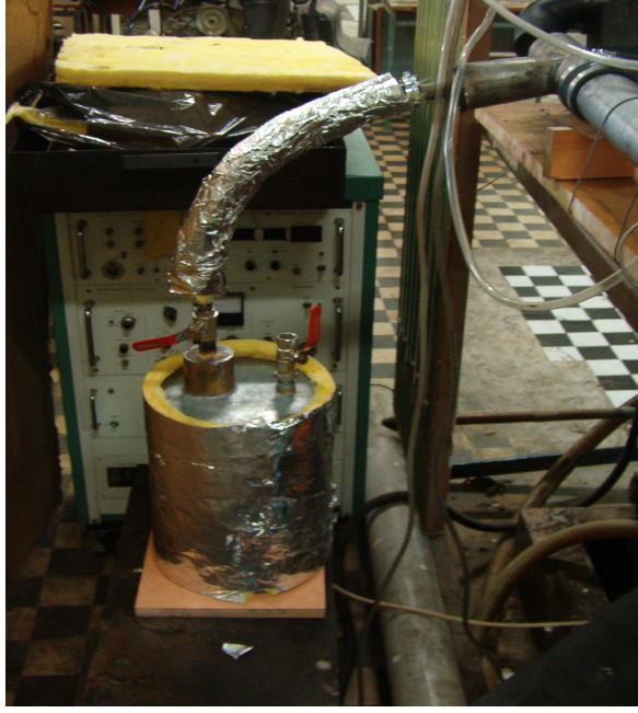
Şekil 4.4 Buhar jeneratörü (üreteci) yandan görünüşü
