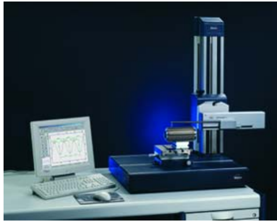
Şekil 5.19 Yüzey pürüzlülük ölçüm cihazı
