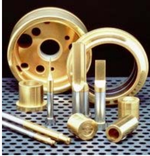
Şekil 4.9 TiN kaplamalı kesici takım örnekleri
