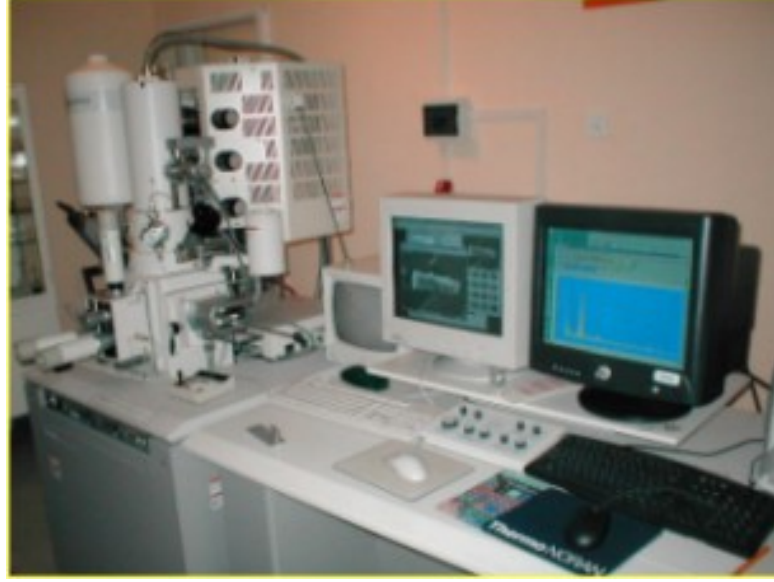
Şekil 5.5 Jeol 5410 Taramalı elektron mikroskobu
