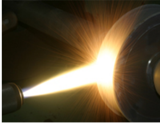
Şekil 2.2 Soğuk püskürtme yöntemi uygulanan iş parçası görüntüsü
