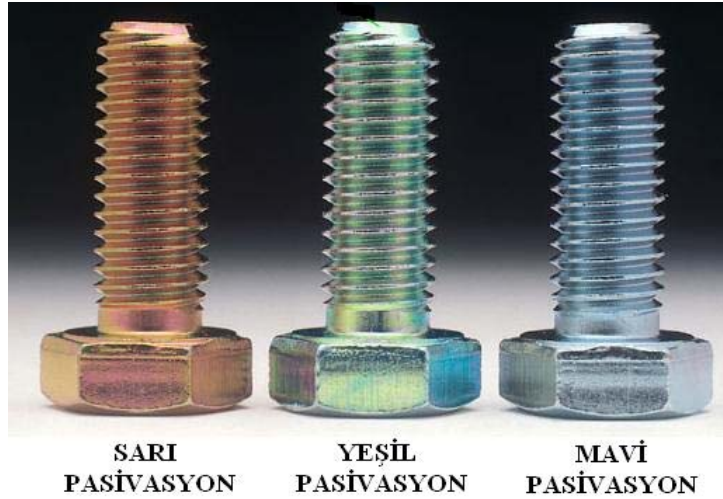
Şekil 2.5 Elektrolitik çinko kaplamanın farklı pasivasyonlar uygulanmış civata örnekleri
