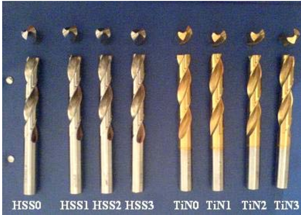
Şekil 5.2 Çalışmada kullanılan matkap uçlarının kesilmiş uç ve gövdeleri
