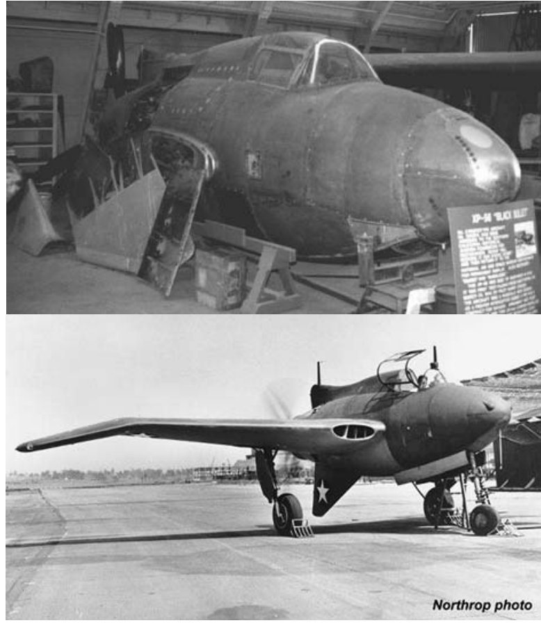
Şekil 2.1 Tamamına yakını magnezyum alaşımından üretilen ilk uçak Northrop XP-56 (Friedrich ve Mordike, Magnesium Technology, 2006)
