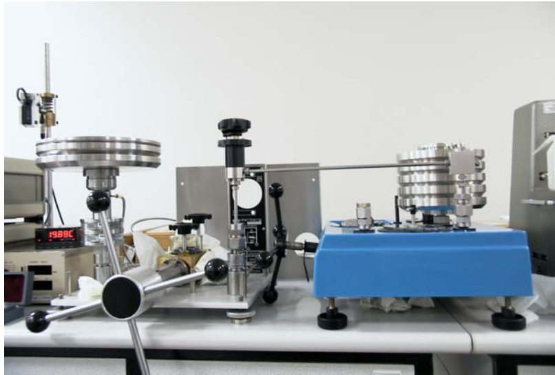
Şekil 3.8 Karşılıklı dengeleme yöntemi deney düzeneği
