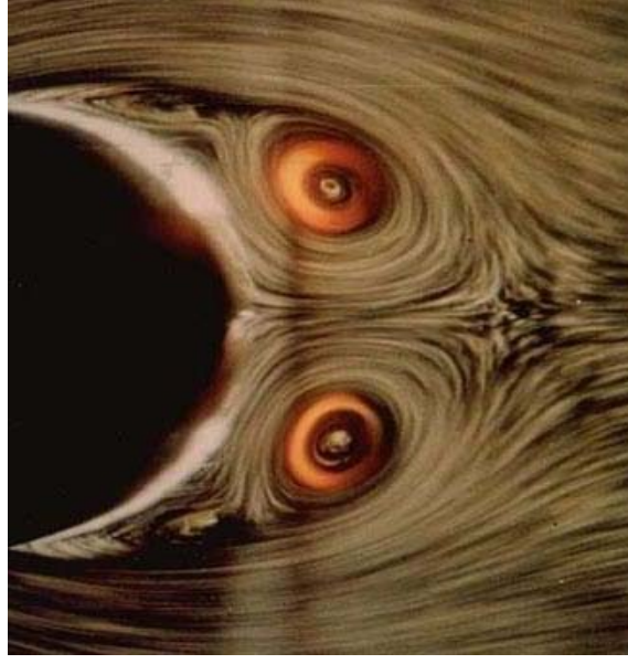
Şekil 4.32 Boru üzerinden akış deneysel çalışmasından alınmış bir fotoğraf
