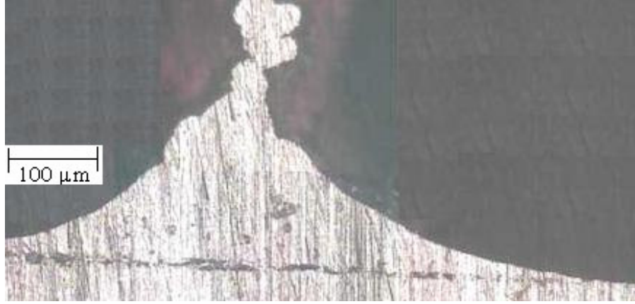
Şekil 7.18 Biriktirilmiş bakırın kesit görüntüsü A=3 mA., h=2mm, t=50dak.
