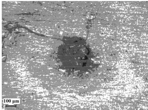
Şekil 7.19 A=3 mA., h=2mm, t=30dak. şartlarında birikmiş bakırın üstten görünümü
