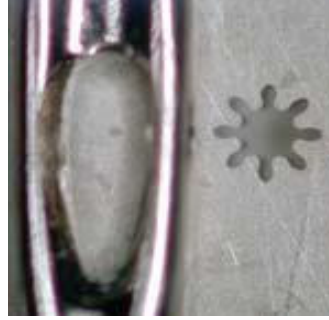
Şekil 2.17. UV-Litografi teknolojisi ile üretilmiş kalıp çukuru [4]
