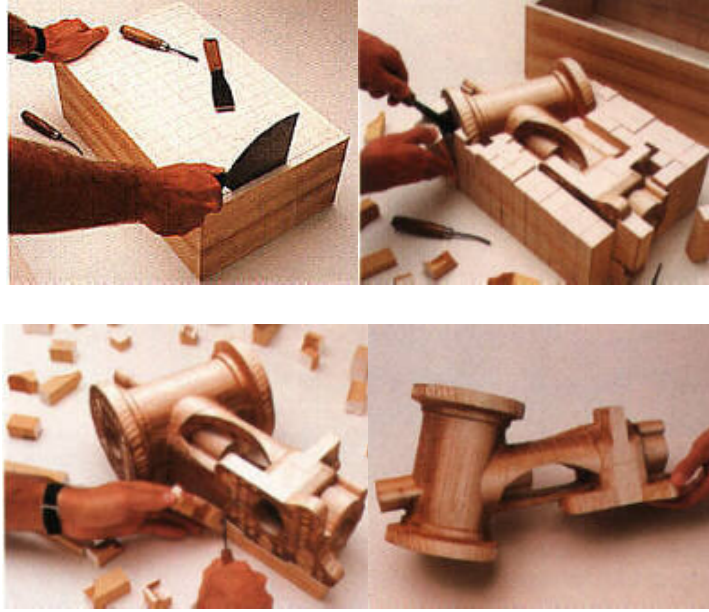
Şekil 4.10 Yapıştır + kes sistemiyle üretim sonrası [26]
