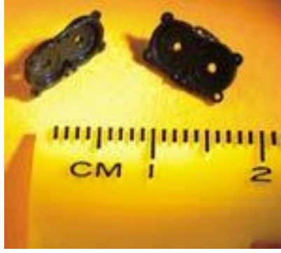
Şekil 2.14 Mikro su motoru dişli kutusu [4]
