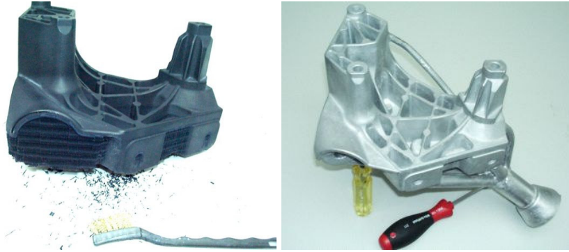
Şekil 4.8 Thermojet yöntemiyle elde edilmiş model ve bu modelin harcanması sonucuyla hassas döküm ile elde edilmiş parça [26]
