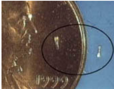
Şekil 2.16 Mikro kalıplama yöntemi ile üretilmiş parça [4]
