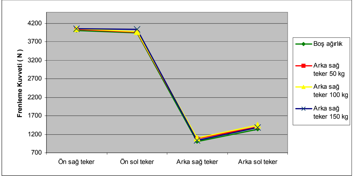
Şekil 5.30 Örnek 3 marka otomobilin sağ arka tekerleğine uygulanan 50, 100 ve 150 kg lık yükler sonucu tüm tekerleklerdeki frenleme kuvvetleri ve değişimleri.
