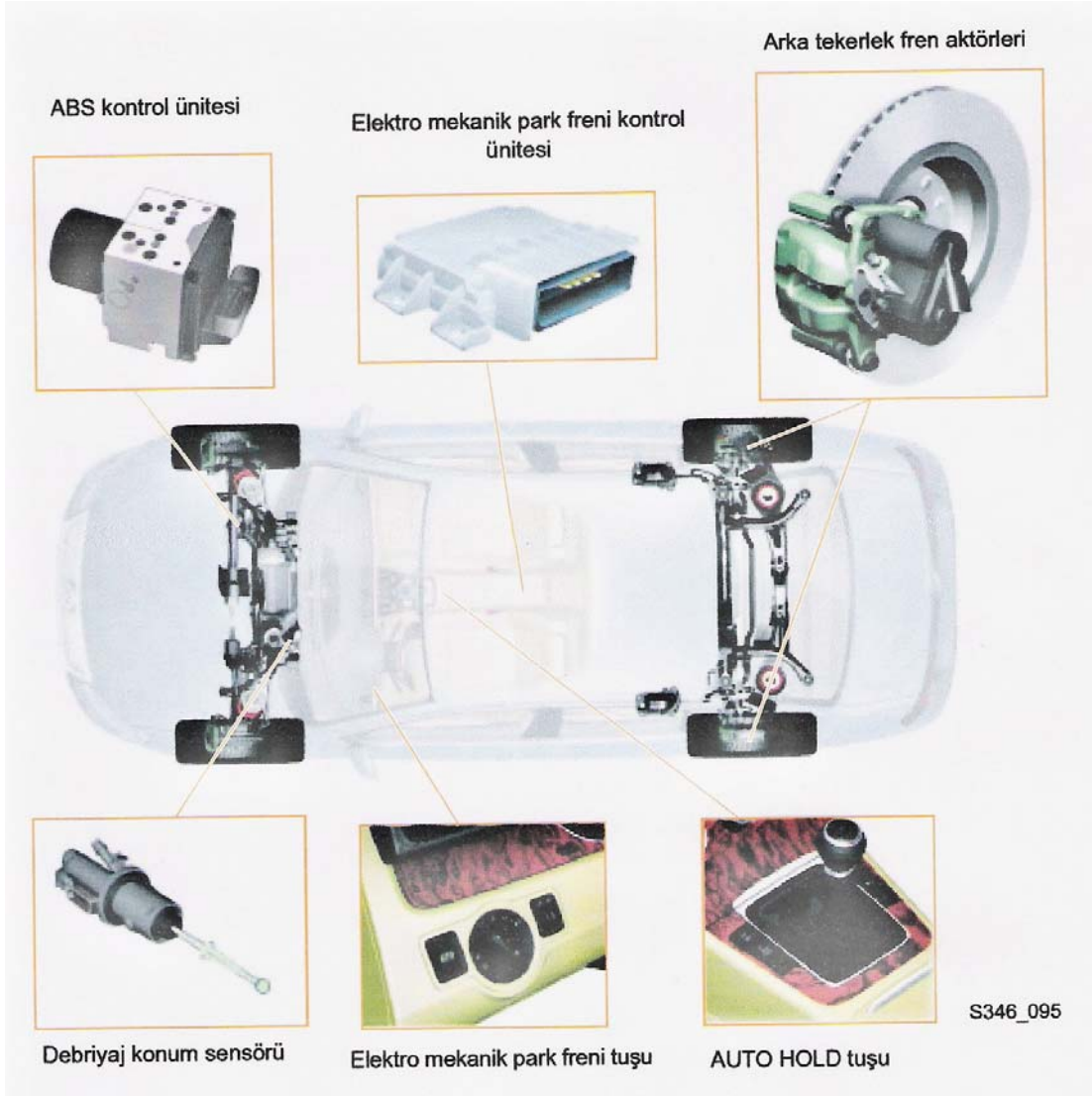
Şekil 6.3 Elektrikli park frenini oluşturan parçalar. ( VW eğitim notları )
