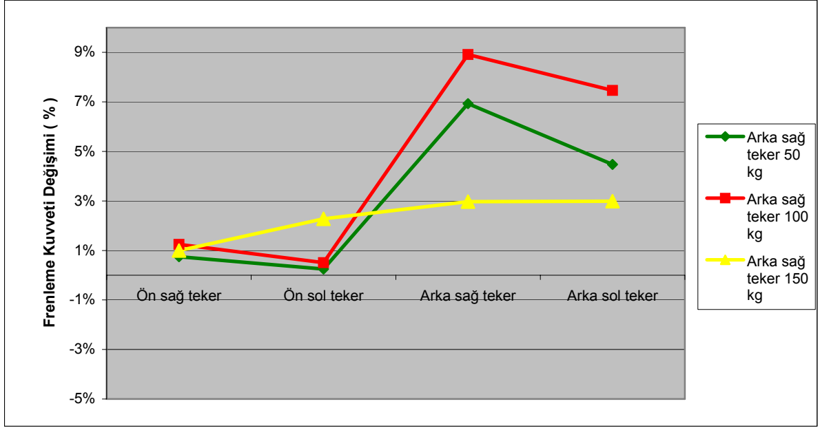
Şekil 5.31 Örnek 3 marka otomobilin sağ arka tekerleğine uygulanan 50, 100 ve 150 kg lık yükler sonucu frenleme kuvvetinin, aracın boş durumundaki frenleme kuvvetine göre % değişimi.
