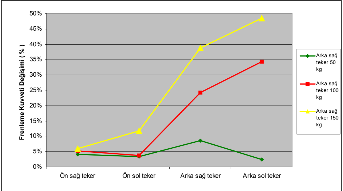
Şekil 5.22 Örnek 2 marka otomobilin sağ arka tekerleğine uygulanan 50, 100 ve 150 kg lık yükler sonucu frenleme kuvvetinin, aracın boş durumundaki frenleme kuvvetine göre % değişimi.
