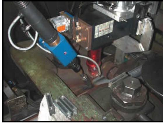
Şekil 2.6 Hibrid proses (Lazer+MIG Kaynağı) kaynak kafası (Sölch ve Hoffmann, 2004)
