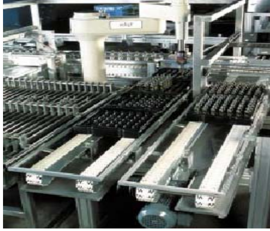
Şekil 5.1. Yakıt enjektörü montaj hattı
