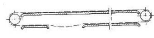
Şekil 2.21. Zincirin bir kızak ile desteklendiği bir uygulama
