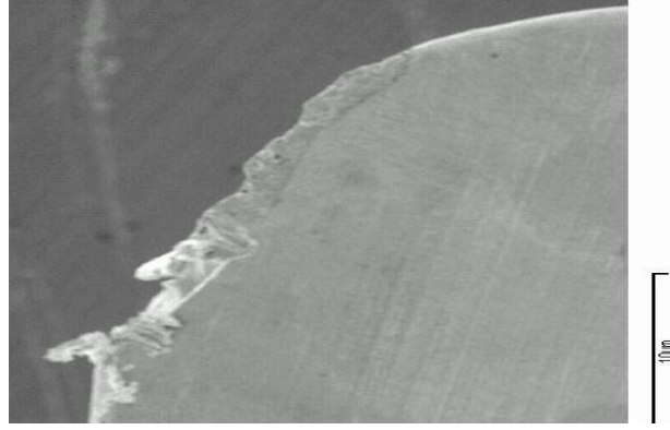
Şekil 5.38 Çizelge 5.4'de yer alan 3nolu parametreler ile yapılan 1sn'lik talaş kaldırma işleminin SEM'de çekilmiş fotoğrafı.
