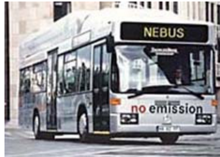
Şekil 7.2. Mercedes-Benz'in hidrojen yakıtlı bir otobüs modeli [13]
