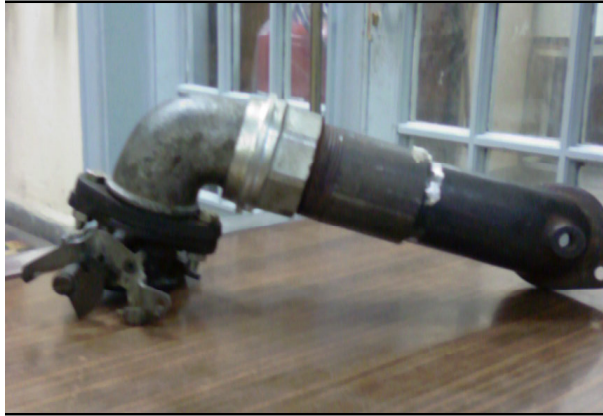
Şekil 8.3. Deney için tasarlanan emme manifoldu
