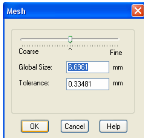
Şekil 6.3.6 Parçaya uygulanan mesh hassasiyeti
