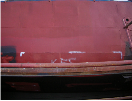
Şekil 6.14 Onarılacak bölgelerin gemi üzerinde işaretlenmesi
