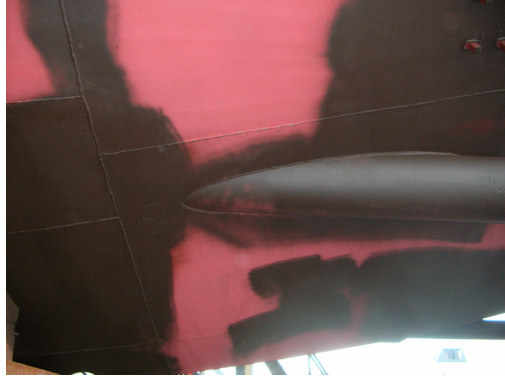
Şekil 6.17 Gemi stern tube bölgesinde, kaynak yerlerinin boyanması
