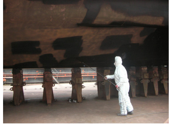
Şekil 6.18 Gemi teknesine yapılan anti-korozif boya uygulaması
