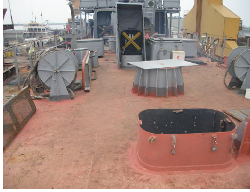
Şekil 6.30 Gemi güvertesinde astar boya uygulaması
