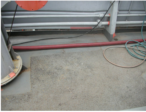
Şekil 6.31 Gemi güvertesinde kumlu boya uygulaması
