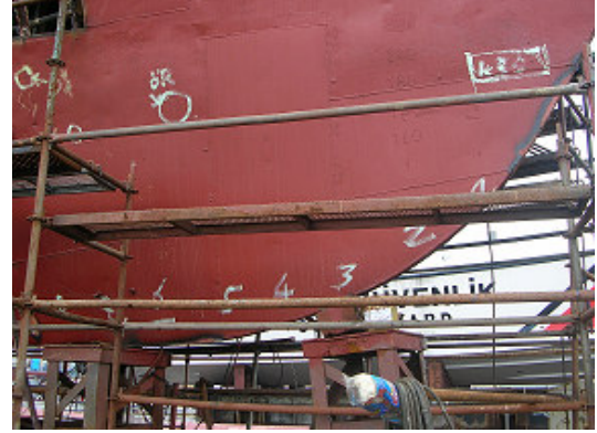
Şekil 6.14 Onarılacak bölgelerin gemi üzerinde işaretlenmesi
