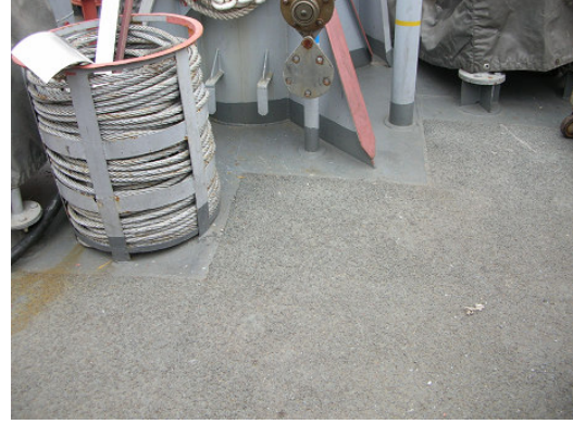
Şekil 6.31 Gemi güvertesinde kumlu boya uygulaması
