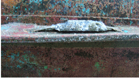
Şekil 6.9 Gemi yalpalığı üzerine yerleştirilmiş tutya
