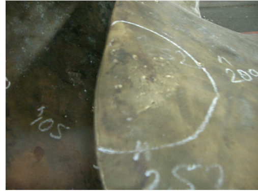
Şekil 6.35 Gemi pervanesinde oluşan korozyon
