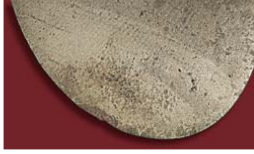
Şekil 2.12 Gemi pervanelerinde kavitasyon [11]
