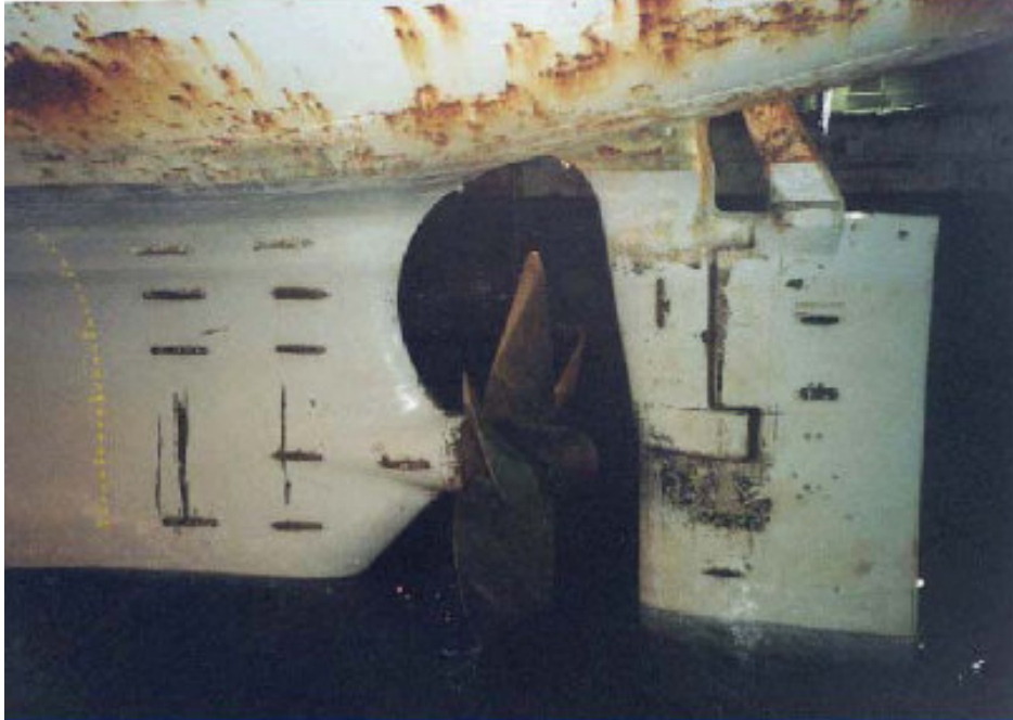
Şekil 4.4 Gemi gövdelerinin harcanabilir anotlarla katodik olarak korunması [3]
