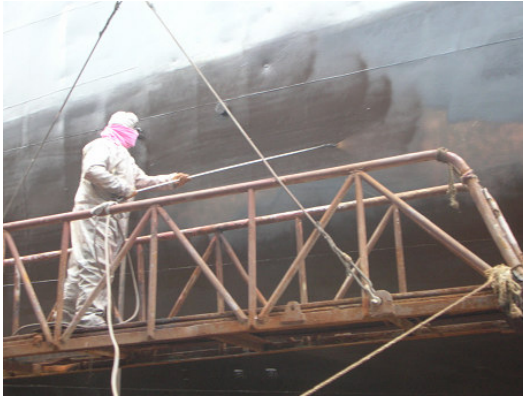
Şekil 6.18 Gemi teknesine yapılan anti-korozif boya uygulaması
