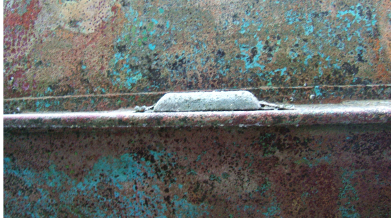
Şekil 6.8 Gemi yalpalığı üzerine yerleştirilmiş, harcanmamış tutya
