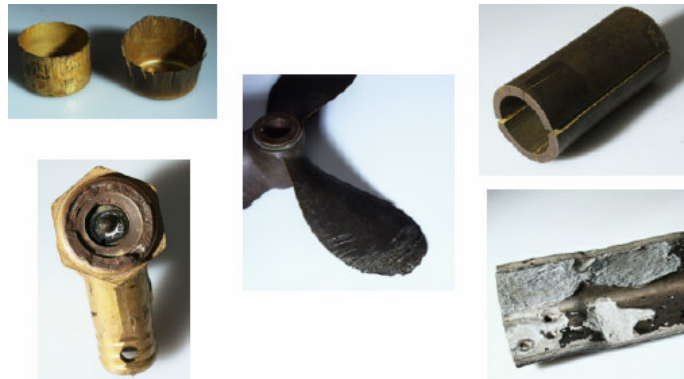
Şekil 2.9 Çeşitli parçalarda oluşan gerilmeli korozyon [3]
