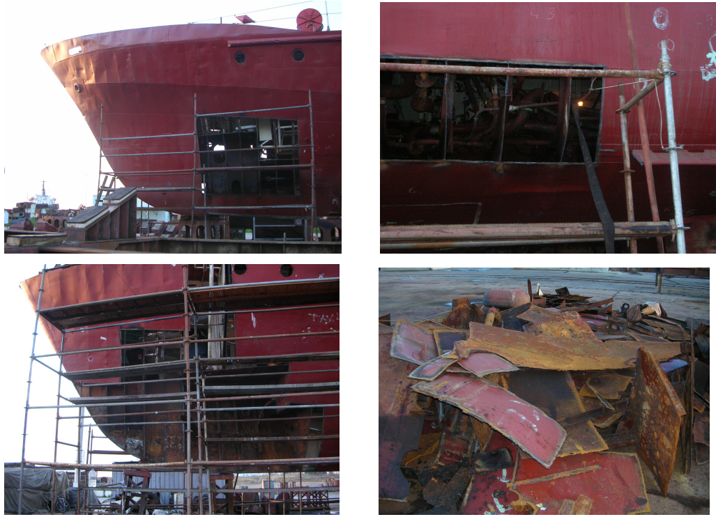
Şekil 6.15 Kesim işleminin ardından gemi teknesinin görünümü
