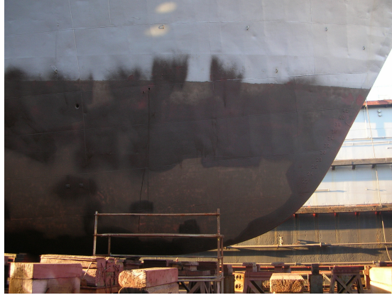
Şekil 6.19 Gemi baş bölgesinin anti-korozif boya uygulaması sonrası görünümü
