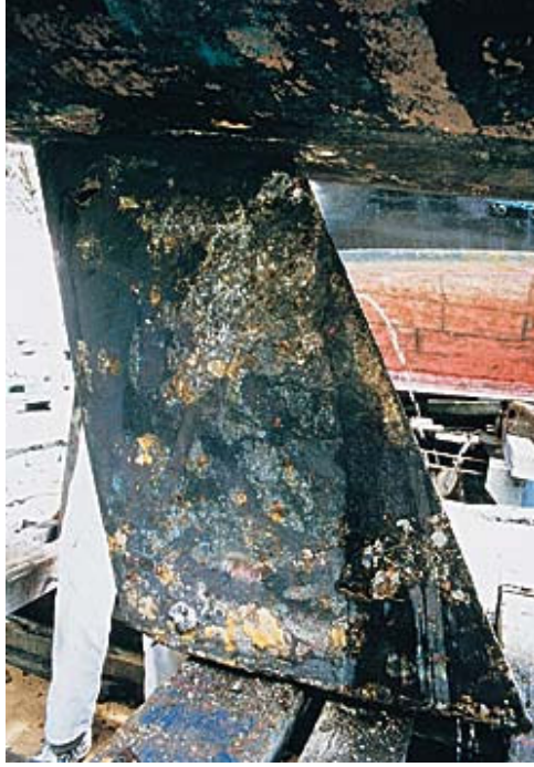
Şekil 2.7 Gemi uskurunda görülen çukurcuk korozyonu [11]
