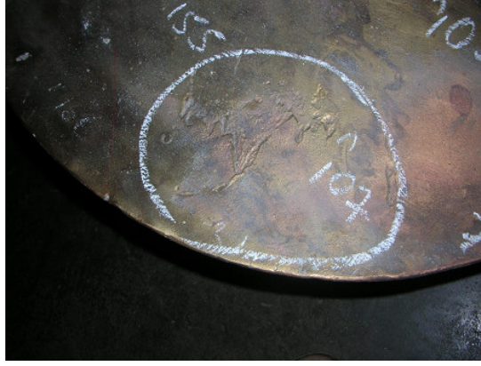
Şekil 6.36 Gemi pervanesine uygulanan dolgu maddesinin kalkması
