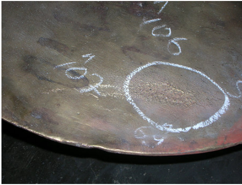
Şekil 6.35 Gemi pervanesinde oluşan korozyon
