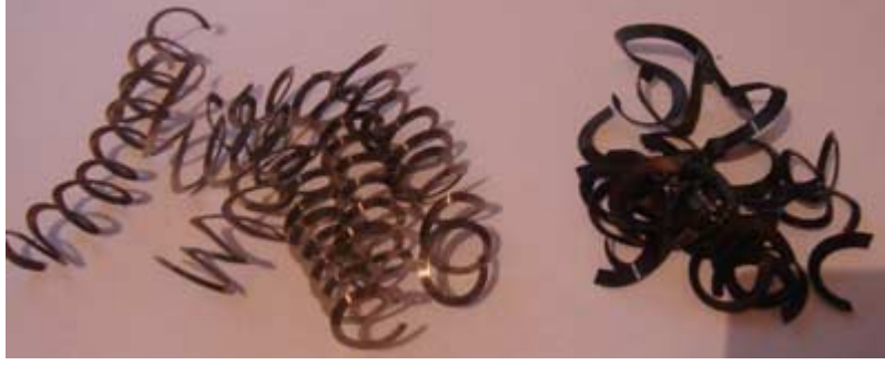
Şekil 9.29 Çözünebilen yağ ile kesme sonucu meydana gelen talaş ( a_p=1.25 ve a_p=2.5\text{mm} ).
