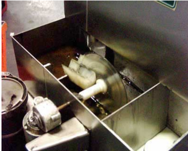
Şekil 6.8 Yağ ayırma ünitesi.
