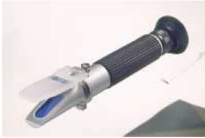
Şekil 4.8 El refraktometresi (Rhenus, 1997)
