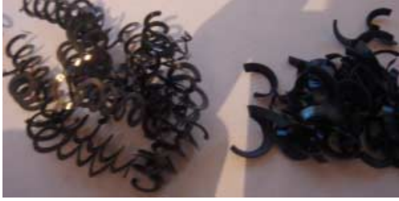
Şekil 9.32 Kuru kesme şartlarında meydana gelen talaş ( a_p=1.25 ve a_p=2.5 mm).
