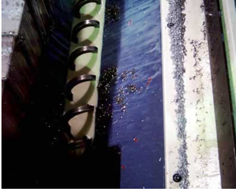
Şekil 5.10 Kesme sıvısının tezgah boyasını kaldırması.
