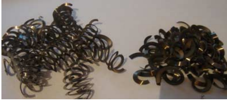
Şekil 9.30 EP katkılı çözünebilen yağ ile kesme sonucu meydana gelen talaş ( a_p=1.25 ve a_p=2.5\text{mm} ).
