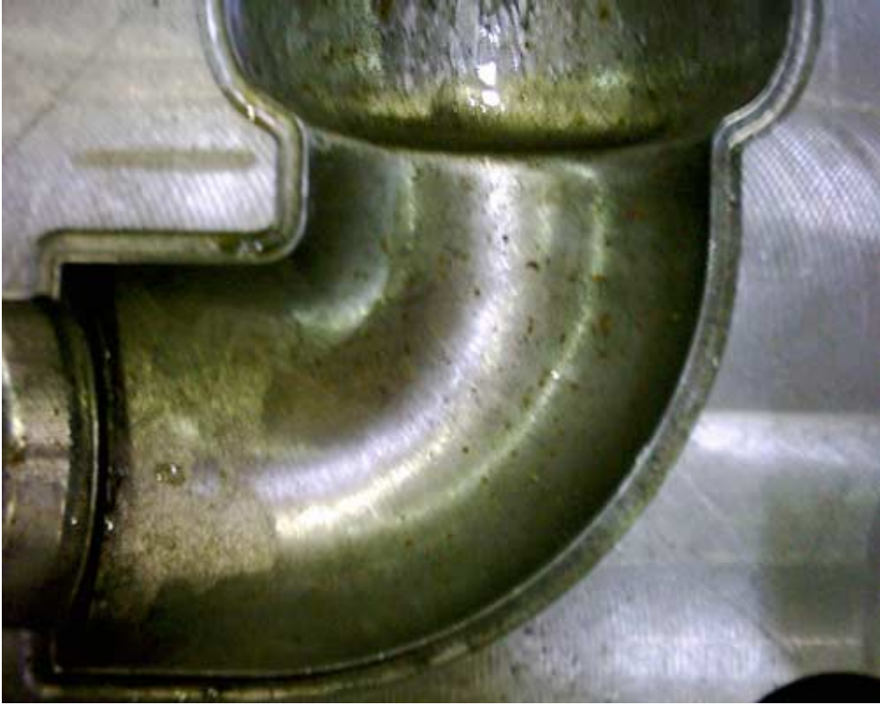
Şekil 5.15 C1050 malzemedен işlenen kauçuk kalıbı üzerinde, işlemeden kalan kesme sıvısının sebep olduğu pas lekeleri.
