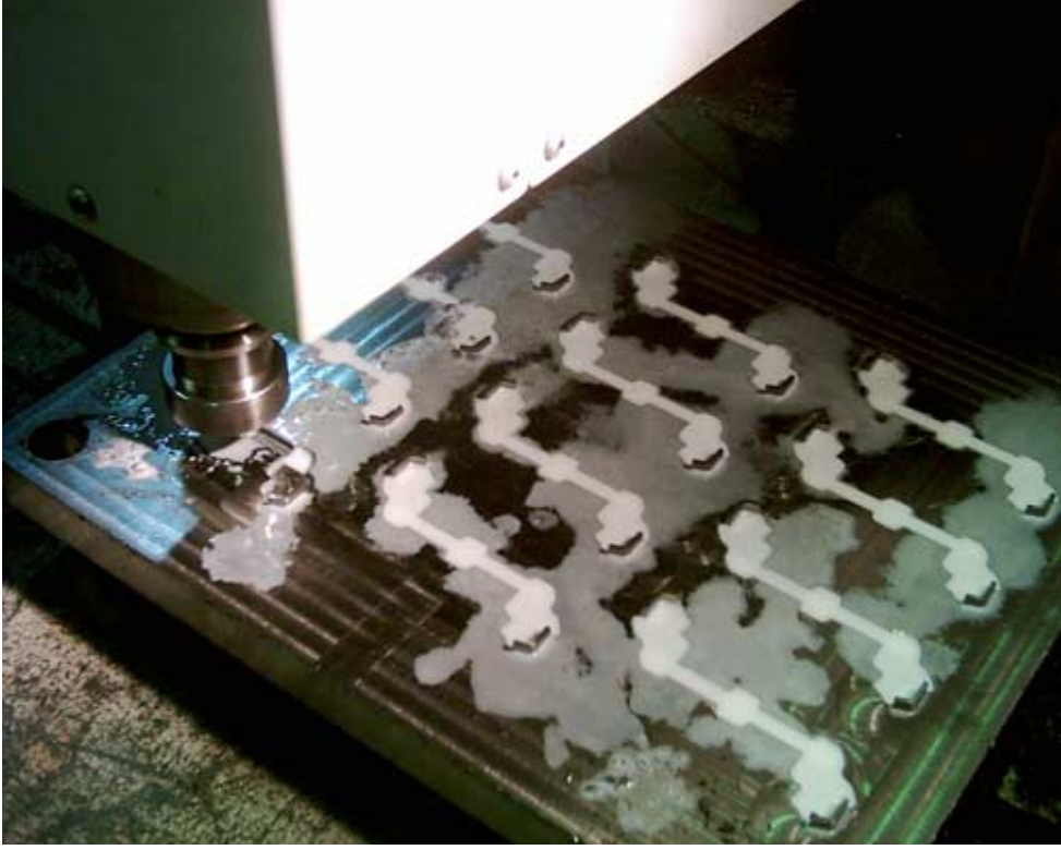
Şekil 5.14 Kesme sıvısının kalıp gözleri içinde birikmesi.
