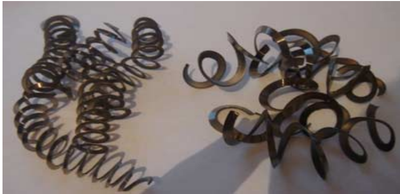
Şekil 9.31 Yarı sentetik kesme sıvısı ile kesme sonucu meydana gelen talaş ( a_p=1.25 ve a_p=2.5\text{mm} ).
