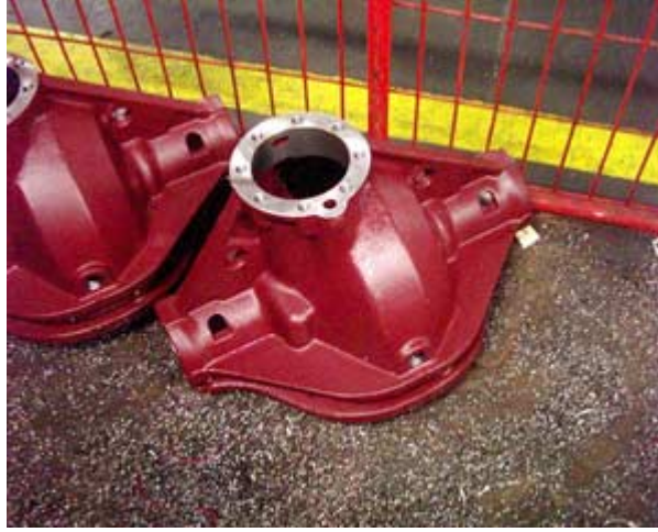
Şekil 7.1 Sfero dökme demir diferansiyel gövdesi (Otoyol, 2005)
