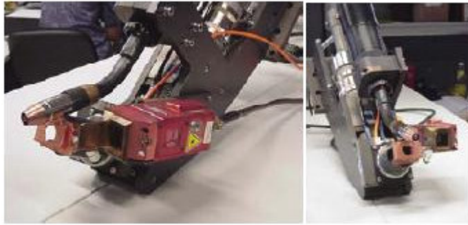
Şekil 1.5 Gemi panellerinin kaynağında kullanılan kaynak kafası [Madsen, Bro (2004)]
