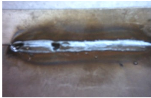
Şekil 3.10 Kaynak malzemesinde delik oluşumu
