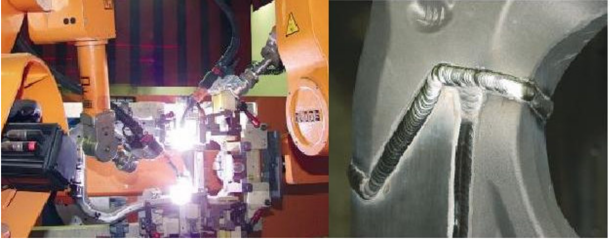
řekil 1.8 BMW K 1200 S řasesinin kaynaęı ve MIG kaynak dikiřleri
