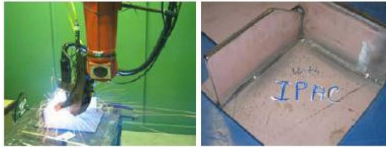
Şekil 1.6 Sade MIG ve hibrit kaynak yöntemleri ile köşe kaynağı [Madsen, Bro (2004)]
