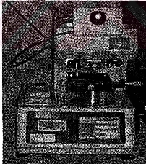
Şekil 7.15 HVM-2000 shimadzu mikrosertlik test cihazı
